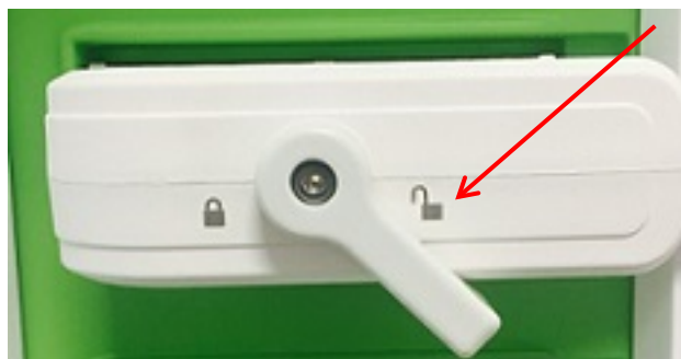
Afbeelding 9: Vergrendelknop transducerconnector in ontgrendelde stand
