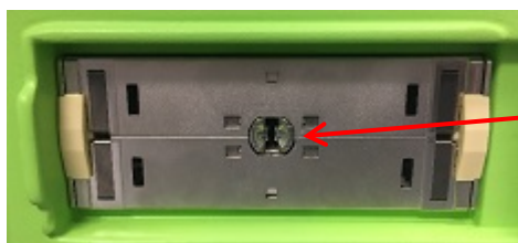
Afbeelding 7: Vergrendelgroef op de transducerconnectorsleuf
